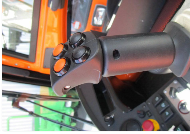
Diverses possibilités de commande sont disponibles pour le pilotage des fonctions hydrauliques
