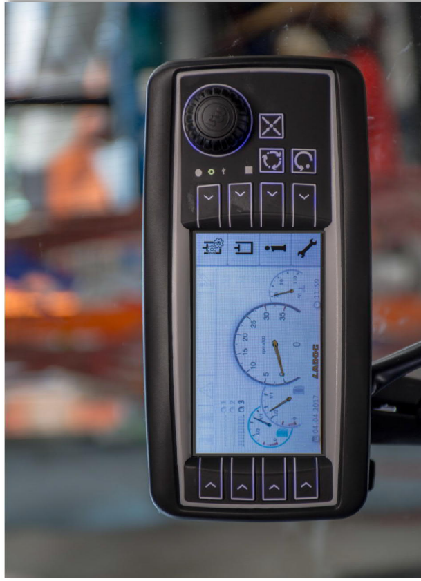
Toutes les fonctions importantes sont affichées clairement et confortablement sur l'écran multifonction.
