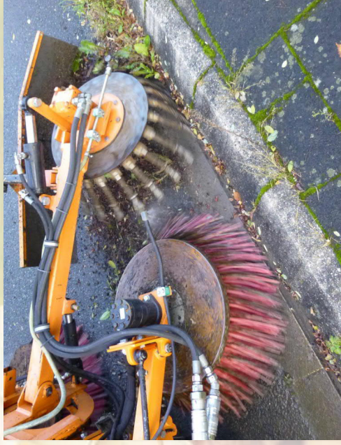
Brosse de désherbage en tant qu'alternative puissante à la lutte contre les mauvaises herbes
