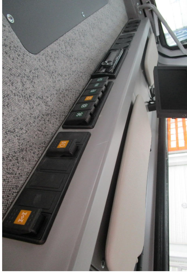
Divers boutons fonctionnels, radio et tachygraphe, logés de manière bien ordonnée, et sont facilement accessibles dans la console du toit.
